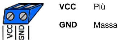
Fig. 4: Alimentazione di tensione (blu)
