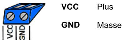
Fig. 4: Raccordement à l'alimentation en tension (bleu)
