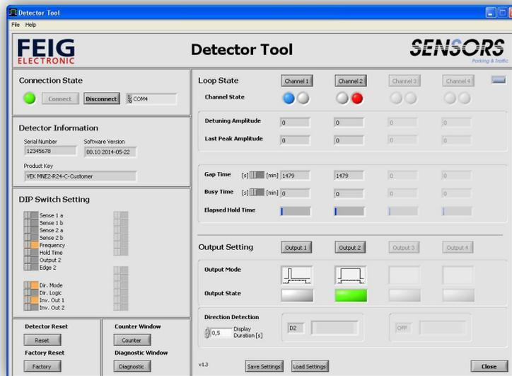
Inoltre, vengono visualizzati i dati correnti come frequenza della spira, sintonizzazione della spira induttiva, ultima durata di segnale occupato, durata tra due segnali di occupato, tempo di attesa trascorso, stato dell'uscita a relè e direzione di marcia rilevata per la diagnostica.
