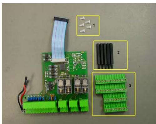
Abbildung 1: RFUxE mit Montagesatz und Steckblockklemmensatz
